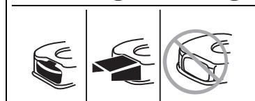
Опасность получения травм – Работать только с установленной заглушкой.
