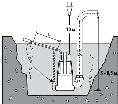
**Примечание!** Следует иметь в виду, что уровни включения и выключения насоса регулируются **ОДНОВРЕМЕННО**. Поэтому, при установке определенного верхнего уровня (включения насоса) убедитесь, что в нижнем положении выключатель обеспечивает своевременное (до оголения водозаборных отверстий в нижней части) выключение насоса. Также примите во внимание, что при уменьшении длины  $L$  уменьшается разность уровней включения и выключения.
